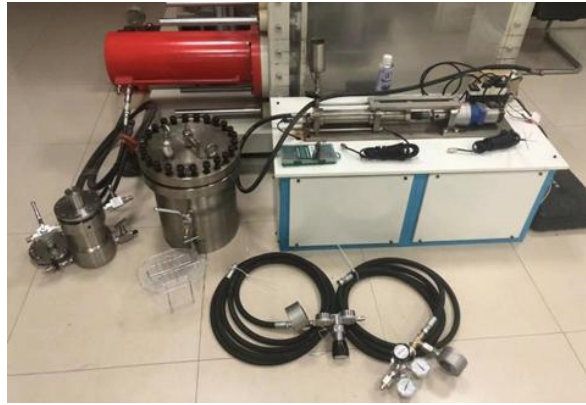
图2 煤岩应力-水/气耦合试验系统
