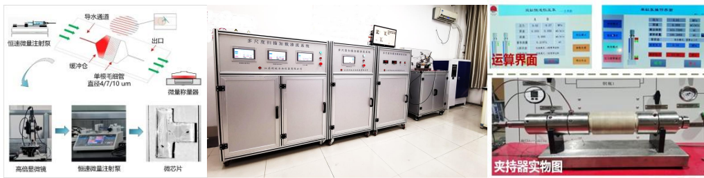
图3 纳米复合流体制备与煤岩微渗测试系统
